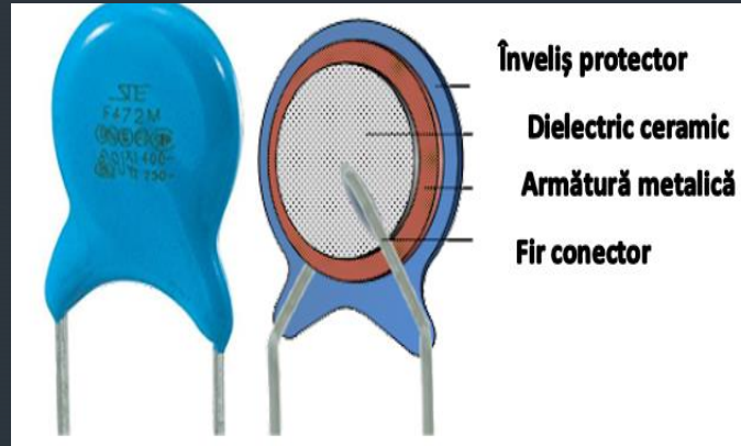
Condensatoare ceramice Structura internă a unui condensator ceramic
